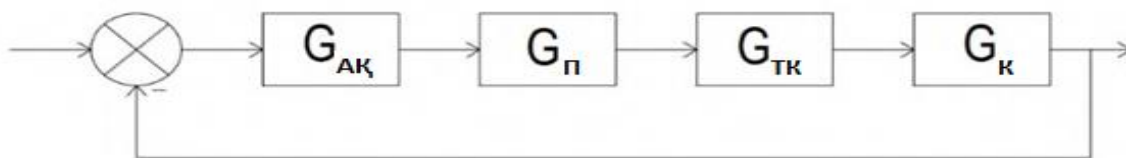
2.5 - сурет – Пешті басқарудың жабық жүйесінің құрылымдық схемасы
